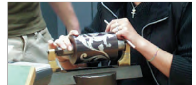
Herstellung einer Musterwalze (»Molettengravur«).
