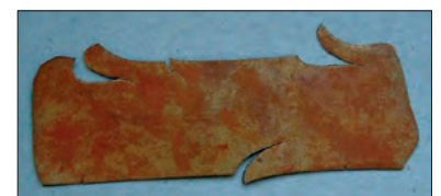
Beispiele für Walzfehler an Messingblech und -draht: Verzogen durch einseitig
