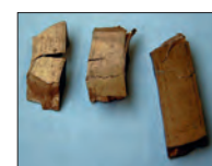
Beispiele für Walzfehler an Messingblech und -draht: Verzogen durch einseitig
