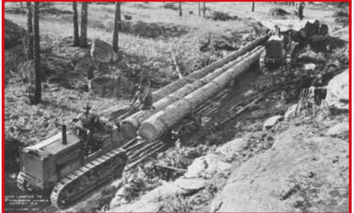
10-Tonnen-Raupen von Holt bei Holzarbeiten 1927. Raupen kamen überall zum Einsatz, wo Radschlepper mit ähnlicher Zugleistung eingesunken wären. (Foto: © NARA, PD)
