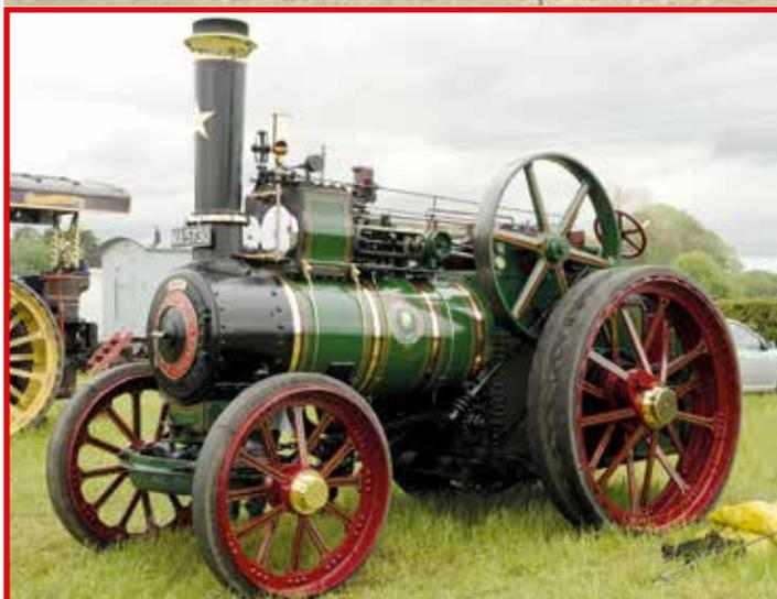
Das ist »Winnie«, ein Veteran aus dem Hause Foster bei der Ashley Hall Traction Engine Rally 2015. Lokomobile leisteten etwa zehn PS, dann drehte sich die Schwungscheibe rund 140 Mal pro Minute. (Foto: © SG2012, cc-by-sa 2.0)
