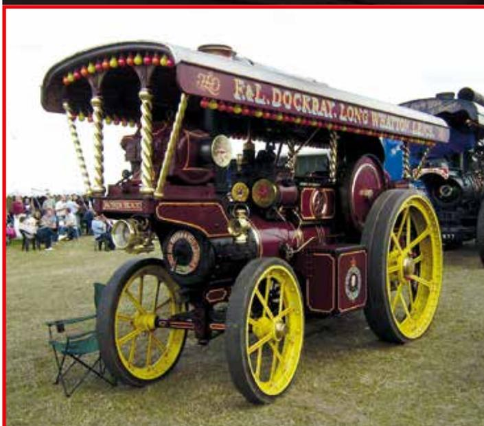
Schon damals war man bestrebt, die teuren Maschinen mehrfach zu nutzen. So konnte man beim Hersteller Rahmen und Räder kaufen, um eine stationäre Dampfmaschine mobil zu machen. Hier »Robin Hood«, die Nummer 14431 der William Foster & Co bei der Cromford Steam Fair 2008 (Foto: © BulldozerD11, cc-by-sa 3.0)
