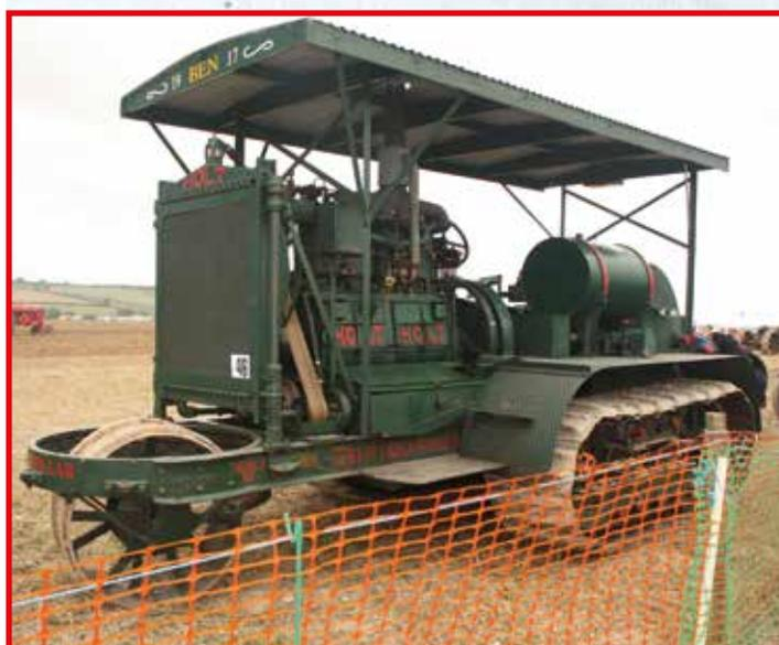
Der Caterpillar-Traktor Holt 75 wurde im Ersten Weltkrieg als Artillerietraktor eingesetzt. Spätere Modelle wurden ohne das vordere »Steuerrad« produziert. (Foto: © BulldozerD11, cc-by-sa 3.0)
