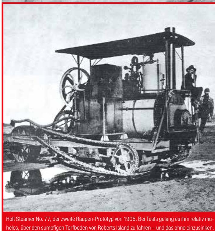
Holt Steamer No. 77, der zweite Raupen-Prototyp von 1905. Bei Tests gelang es ihm relativ mühelos, über den sumpfigen Torfboden von Roberts Island zu fahren – und das ohne einzusinken.
