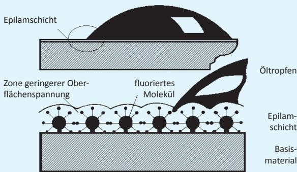
Die Antispread-Schicht liegt netzartig auf der Oberfläche. Die Kunststoffmoleküle polymerisieren auf dem Feststoff. Die „Fluorborsten“ stoßen das Öl ab.
