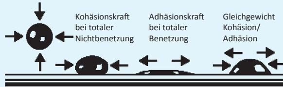
Antispread senkt die Oberflächenspannung des Festkörpers soweit, dass selbst Silikonöl nicht mehr breitleiten kann.
