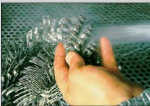
Reinigen von Gussbäumen mittels Hochdruck-Wasserstrahl ohne weitere Zusätze.
