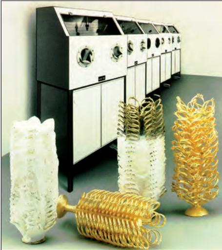
Strahlkabinen zum Nassstrahlen (Wasser mit oder ohne Schleifkörnchen) von Gussbäumen nach dem Gießen im Wachs-aus-schmelzverfahren.
